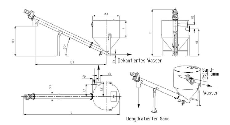
Die Aufgabe vom Sandentwässerer ist das Absetzen des zugeführten Sandschlammes und das Entfernen des abgesetzten Sandes.
